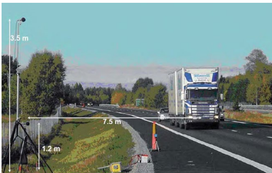
Bild 16. Bullermätning med SPB-metoden. Foto: Ulf Sandberg, VTI.
