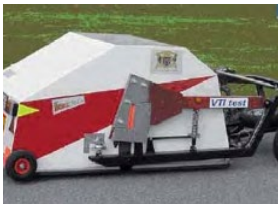
Bild 14. Bullermätning med CPX-metoden med hjälp av mätvagn. Källa: Ulf Sandberg, VTI.
